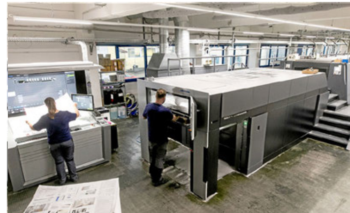
Der Maschinenpark des Unternehmens verfügt unter anderem über moderne Sechs- und Achtfarben-Offsetdruckmaschinen. Fotos: Ralf Lienert
